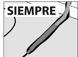
Incruste **SIEMPRE** completamente empalme de fábrica y todo el cable calentador en la argamasa. No doble **NUNCA** el empalme ni ponga parte del mismo en la pared a en el suelo.
