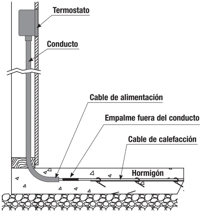
Los terminales eléctricos de SlabHeat hacen la transición desde la losa al control o la caja de conexión eléctrica a través del conducto.
