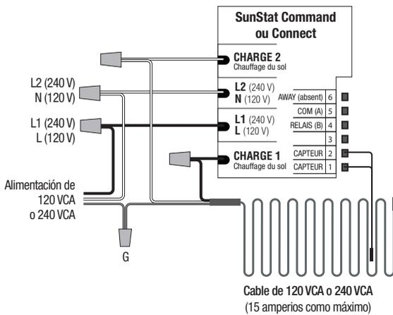
**Diagrama de cableado eléctrico de varios cables con control SunStat (120/240 VCA)** Circuito exclusivo de 120 o 240 VCA, 20 amperios (máximo) (carga máxima de 15 amperios mediante el control SunStat).
