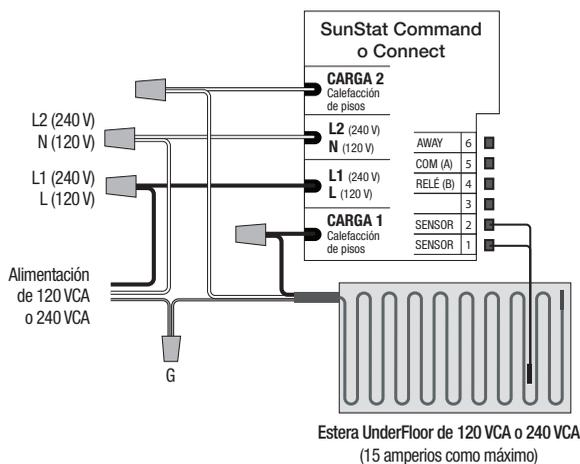
**Diagrama de cableado eléctrico de varias esteras UnderFloor con control SunStat (120/240 VCA)** Circuito exclusivo de 120 o 240 VCA, 20 amperios (máximo) (carga máxima de 15 amperios mediante el control SunStat).
