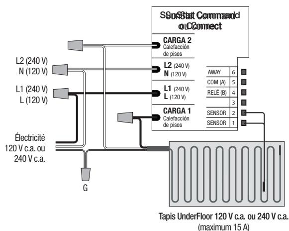
**Diagramme de câblage électrique pour plusieurs tapis UnderFloor avec commande SunStat (120/240 V c.a.)** Ligne dédiée de 120 ou 240 V c.a., 20 A (maximum) (charge maximum 15 A avec une commande SunStat).
