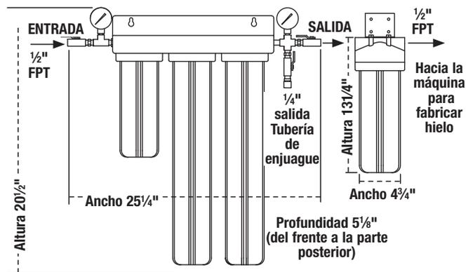
**Nota:** deje 3" de espacio libre en la parte inferior del sistema para la extracción de los recipientes del filtro al reemplazar el cartucho para el filtro
