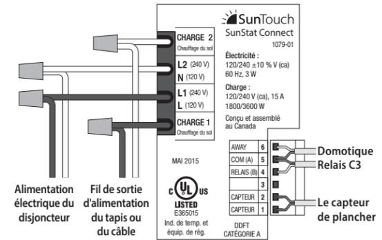
Les raccords de capteur, relais et domotique sont réalisés au niveau de la plaque à bornes en insérant les fils dans les ouvertures carrées et en serrant les vis sur le coté.
