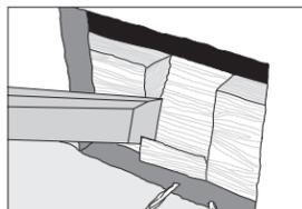
**Pour les installations de mise à niveau, coupez la cloison sèche et découpez la plaque de base pour acheminer les fils vers la commande.**
