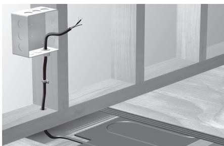
Les faux plafonds sous les tapis devront être équipés de porte ou de plaque d'accès pour accéder aux boîtiers de raccordement installés entre les solives. Une autre option est d'installer les boîtiers de raccordement dans l'espace au dessus avec une plaque couvrante.
