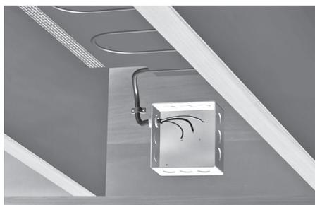
Les plafonds suspendus ou incomplets sous les tapis permettent l'installation des boîtiers de raccordement entre les solives.
