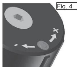
La température de départ est pré-réglée sur la valeur indiquée dans le tableau **5. CARACTÉRISTIQUES TECHNIQUES / MATERIAUX** au départ d'usine. Dans cette position, l'aiguille d'indication est à fleur de la molette de réglage (voir fig. 4).
