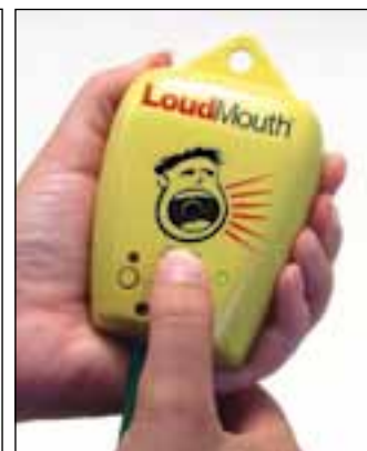
Mettez l'interrupteur à la position « ON » (marche). Le témoin vert devrait s'allumer.
