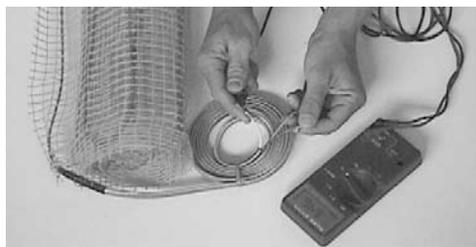
**Avant de commencer l'installation, enregistrez les relevés de résistance dans le journal de résistance de treillis et de capteur plus bas. Pour conserver la garantie limitée, il faut enregistrer ces résistances et autres données.**
